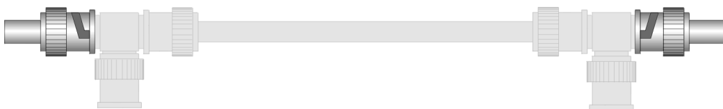
Verbindungsabschluss beim 10 Base-2-Netzwerk
