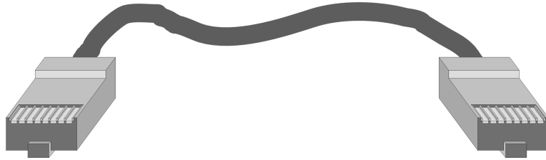
"gekreuztes"-Kabel für den Einsatz von 10 Base-T mit RJ-45-Verbindern
